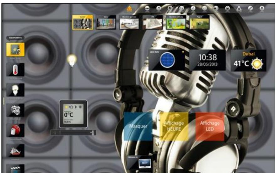
Infine, per completare questo esempio, abbiamo posizionato un painter (blu) che permette di nascondere la pagina statica e invisibile che abbiamo reso visibile e anche di ritrovare lo stato di partenza. Per fare questo, è sufficiente definire una nuova azione "jump" nel « What I Do » che fa il collegamento alla pagina selezionata : la pagina « salone » nel nostro esempio.
