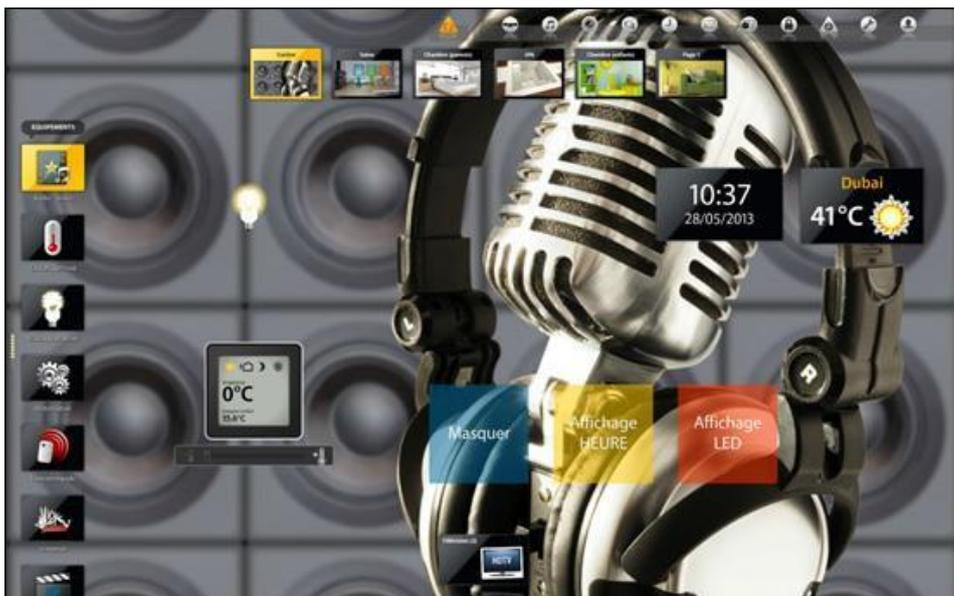
Cliccando sul painter « visualizzazione LED », la pagina statica collegata dal jump è resa visibile e il widget LED appare sullo schermo. Cliccando sul painter « visualizzazione ORA », la pagina statica con i widgets LED sparisce e viene sostituita con la pagina statica con il widget ora. Utilizzando questo metodo, si può visualizzare solo una pagina statica invisibile alla volta.
